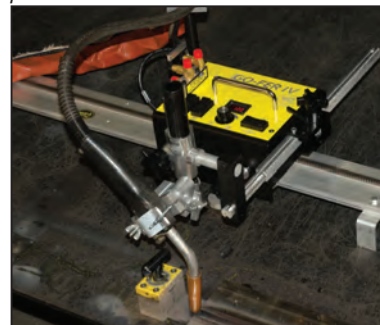
Acima, configuração do Go-fer IV para soldagem
