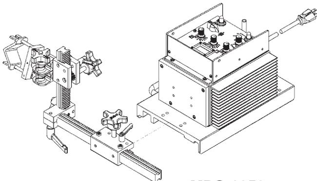
Он состоит из анодированных 7/8" (22,2мм) алюминиевых стержней с 16-ступенчатыми стойками и дорожками, прямыми зажимами, стойками и держателями горелок.
