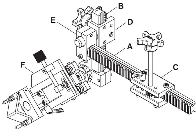
Используемый для слежения за угловым сварным швом, УГЛОВОЙ ПОСЛЕДОВАТЕЛЬ с подпружиненным V-образным колесом удерживает сварочную горелку на стыке и поддерживает ее на необходимом расстоянии. Последователь доступен в правых или левых конфигурациях.
