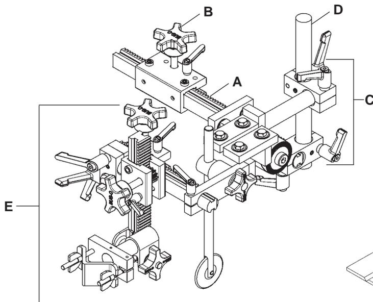
Используемый для слежения за стыковым швом, УГЛОВОЙ ПОСЛЕДОВАТЕЛЬ имеет 2 оси регулировки, определяемые колесом, которое передвигается по шву. Он обеспечивает до 2" (50.8мм) компенсации вверх и вниз, влево и вправо для компенсации неровностей.
