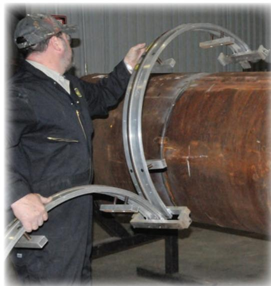
**BRR-3250-XX** Изогнутый жесткий рельс. Легко устанавливается на заготовку для быстрого монтажа и демонтажа
