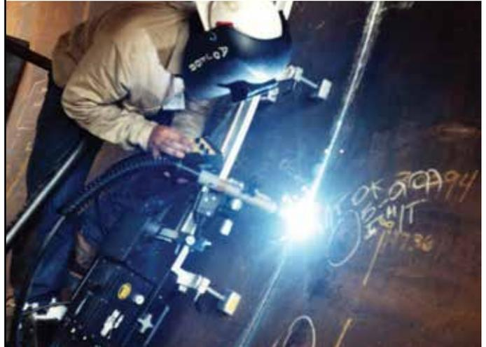
Se muestra arriba - Soldadura con vertical oscilación lineal con barra de soporte ARM-2480 con imanes
