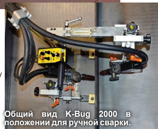
Общий вид K-Bug 2000 в положении для ручной сварки.
