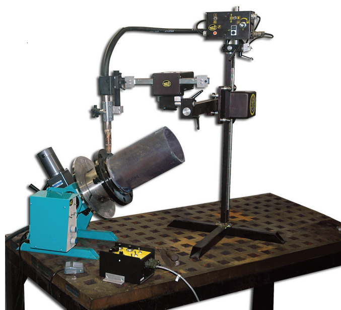
FTS-1025 с модулем линейных колебаний (CDS-6350) и позиционером (BPG-450-L).
