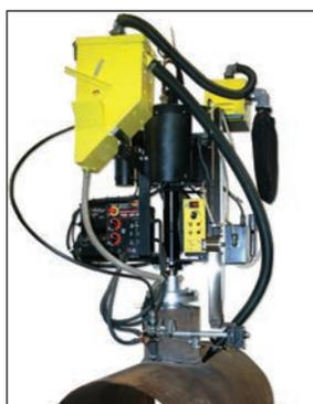
**Программируемый аппарат круговой сварки CWP-18** предназначен для одно- или многопроходной сварки муфт или форсунок на сосудах или куполообразных оголовках с использованием процесса погружной дуги, MIG или с флюсовым сердечником с защитным газом. CWP-18 крепится на 3-е зубом патроне для сварки внешних диаметров 10-50 "(254-1270 мм).
