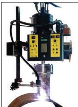
**Программируемый аппарат круговой сварки CWP-5** предназначен для одно- или многопроходной сварки муфт или форсунок с использованием процесса MIG или с флюсовым сердечником, выполняет сварку диаметров 1-12 "(25-305 мм).
