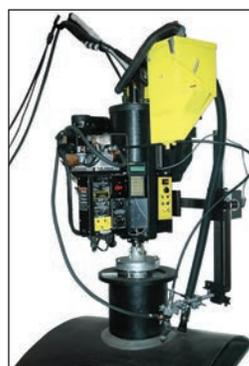
**Программируемый аппарат круговой сварки CWP-11** предназначен для сварки сопел на сосудах, с использованием технологии погружной дуги, MIG или с флюсовым сердечником. CWP-11 крепится на 3-е зубом патроне для сварки внешних диаметров 6-50 "(152-1270 мм).
