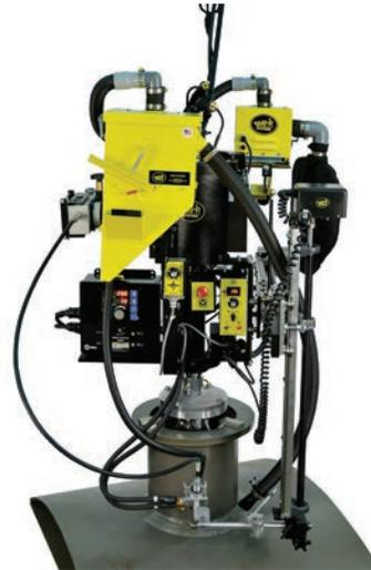
Аппарат круговой сварки DCW-18-M, оснащен цифровым интерфейсом Miller для использования с источниками питания серии Miller Digital. Он способен сваривать диаметры сопел от 10 до 50 дюймов и настроен для работы с погружной дугой.
