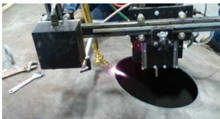
Программируемый станок СВР-3 должен монтироваться на колонне и стреле, манипуляторе или фиксаторе. Он использует кислородно-топливный процесс для резки квадратных или скошенных отверстий (см. Диаграмму с рабочими характеристиками).
