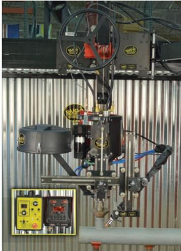
Аппарат круговой сварки DCW-5-L, оснащенный устройством подачи проволоки Lincoln Electric Power Feed 84, может сваривать диаметры 1-12 "(25,4-304,8 мм). Этот аппарат может использоваться для MIG, импульсной MIG и сварки с флюсовым сердечником. Он имеет запоминающее устройство на восемь процедур сварки и предварительно запрограммированные автоматические настройки для упрощения процесса.
