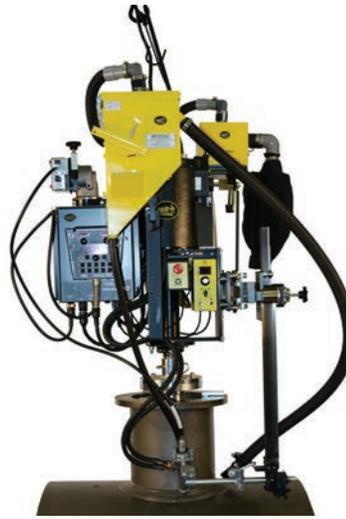
Аппарат круговой сварки DCW-18-L, оснащенный контроллером Lincoln Electric MAXsa 10 для Power Wave AC / DC 1000, может сваривать сопла диаметром 10-50 дюймов. Аппарат настроен для работы с погружной дугой. Аппарат имеет запоминающее устройство на восемь процедур и удобные для пользователя элементы управления.
