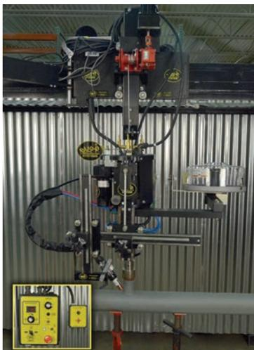
Аппарат круговой сварки DCW-5-O, оснащен устройством подачи проволоки OTC-DAIHEN AF-4012, обеспечивает OTC запатентованный импульсный процесс. Рабочий диаметр 1 "-12" (25,4-304,8 мм).
