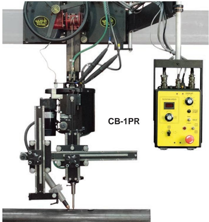
**Аппарат плазменной круговой резки CB-1P (CBO-1020)** предназначен для резки скошенных отверстий в тонкостенных трубах или сосудах. Этот аппарат снабжен источником энергии (по желанию клиента), горелкой и 50 '(15 м) кабелями. CB-1P устанавливается на каретке или крепеже. Более подробную информацию см. онлайн на сайте bugo.com
