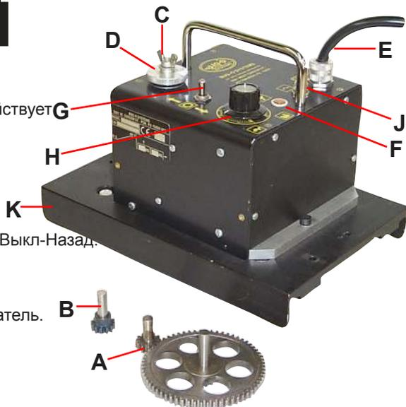
Имеет две шестеренчатые передачи. Установленная на заводе шестерня входит в зацепление с рабочей шестерней, обеспечивая высокий крутящий момент на низких скоростях (А). Пользователь может легко заменить рабочую шестерню и получить низкий крутящий момент и высокую скорость (В).
