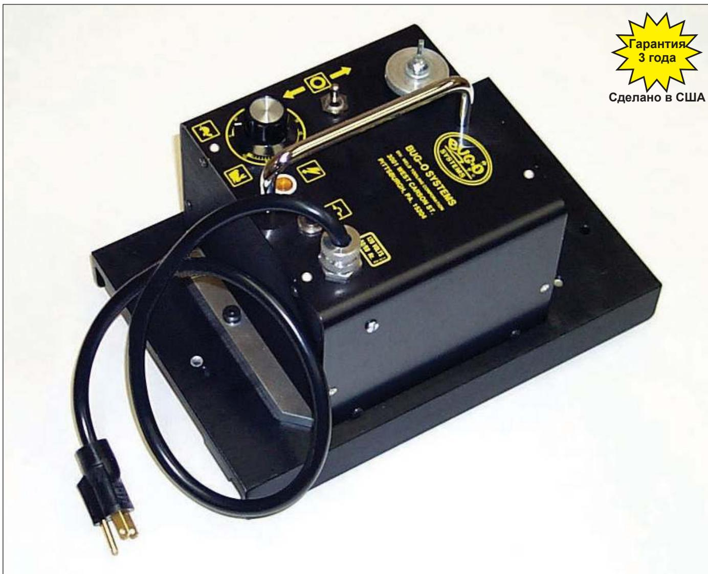
BUG-O DC IV имеет двойной диапазон скоростей, привод с зубчатой шестерней, готовые к монтажу сварочные и режущие приспособления и аксессуары. Он состоит из привода DC IV, установленного на каретке 12" (305 мм). Этот модуль работает на стандартном алюминиевом жестком рельсе и алюминиевом гибком рельсе.
